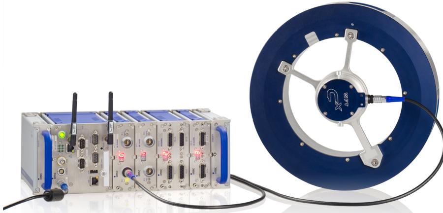
Das WFT-2 ist ein imc CRONOSflex Modul zur Erfassung von zwei WFT Sensordaten.
