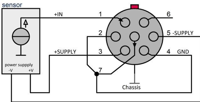
Abb. 39: "3-wire sensor" und bipolare Versorgung ±15 V (UTI-6)
