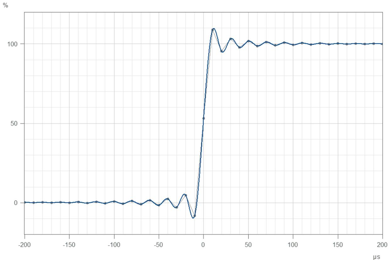
Abb. 24: Sprungantwort bei "Filter-Typ: ohne" für ARGFT/ICPU-6 bei 500 kSps
