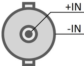
Abb. 48: ICPU-6 Buchse (Belegung, Sicht auf die Buchse)
