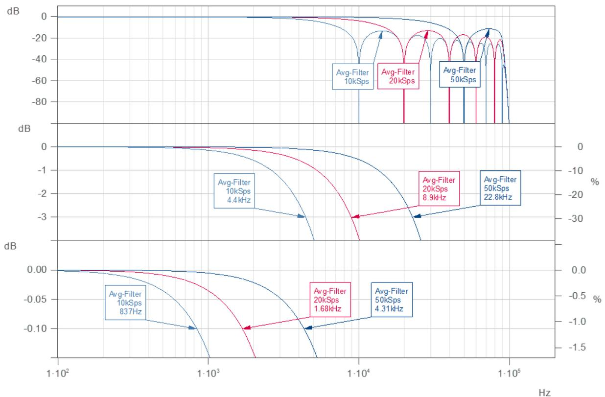
Abb. 21: "Filter-Typ: Mittelwertfilter" für verschiedene Abtastraten ( $f_{s\text{ prim}} = 200\text{ kSps}$ )
