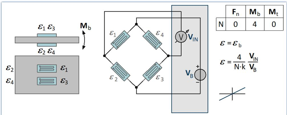
Die Empfindlichkeit des Biegemoments wird erhöht. Gleichzeitig werden Längskraft, Drehmoment und Temperatur kompensiert.
