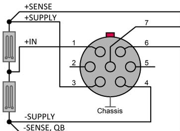
Abb. 29: Anschlußschema B-4 Halbbrücke
