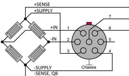
Abb. 31: Anschlußschema B-4 Vollbrücke
