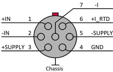
Abb. 47: UTI-6 Buchse (Belegung)
