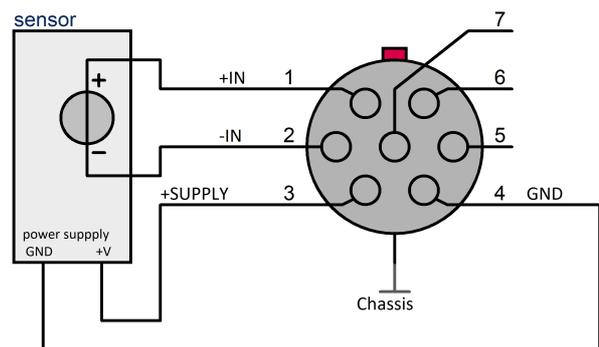
Sensor mit unipolarer Versorgung
