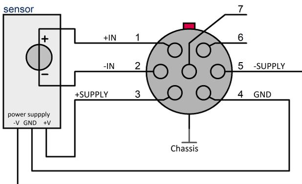
Sensor mit bipolarer Versorgung
