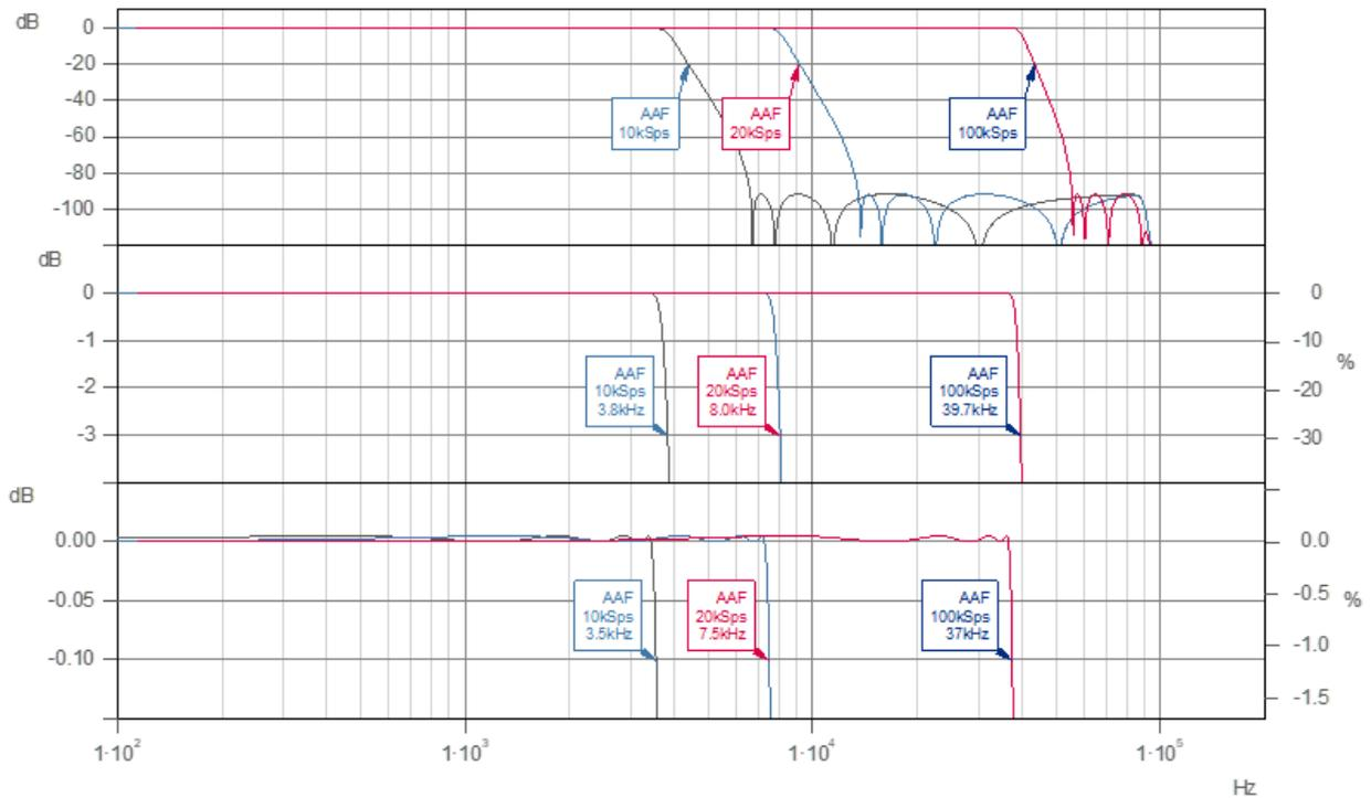
Abb. 20: "Filter-Typ: AAF" (Cauer) für verschiedene Grenzfrequenzen ( $f_s \text{ prim} = 200 \text{ kSps}$ )
