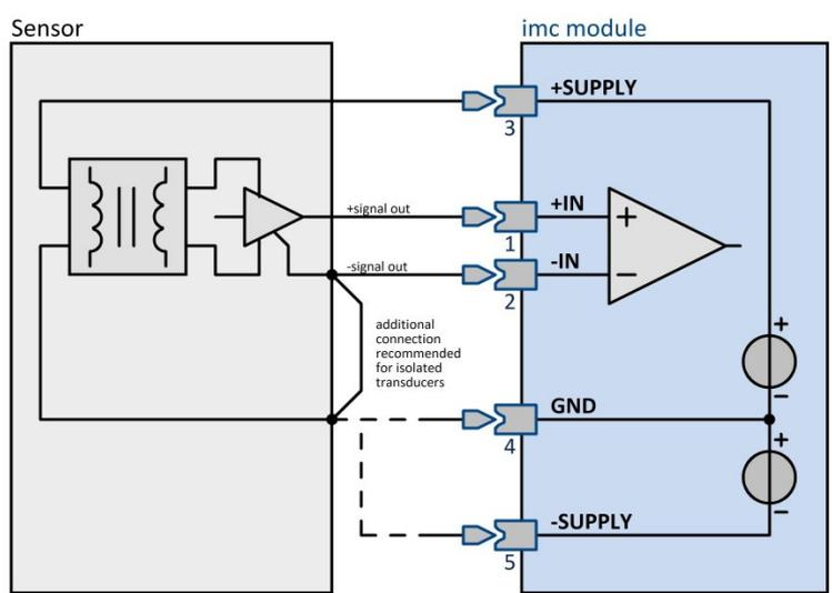
Abb. 41: UTI-6 mit isoliertem Umformer im Sensor
