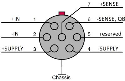
Abb. 46: B-4 Buchse (Belegung)
