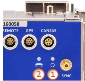
Abb. 10: LEDs der ARGFT-BASE
