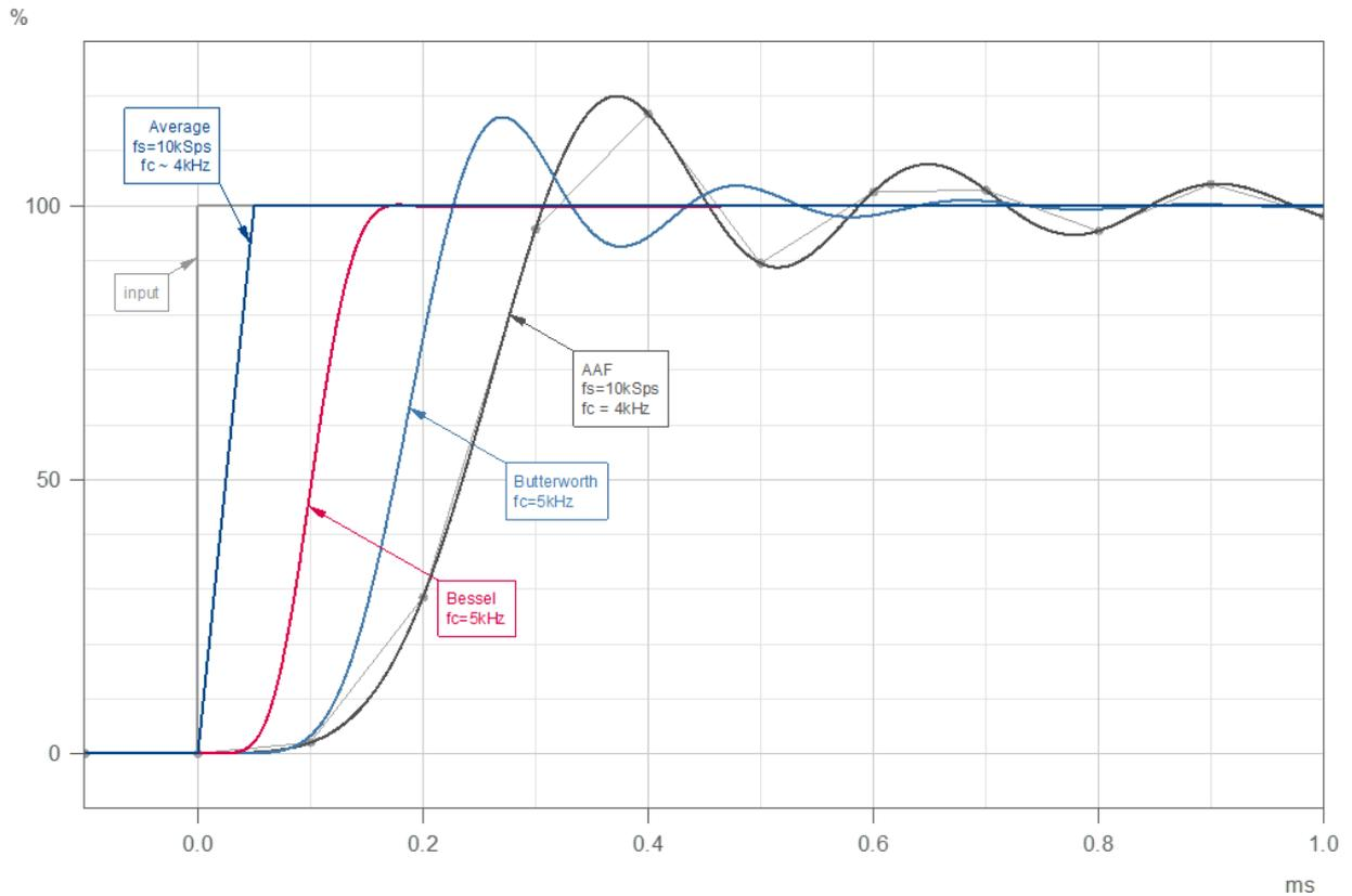
Abb. 19: Vergleich der Sprungantwort verschiedener Filtercharakteristiken
