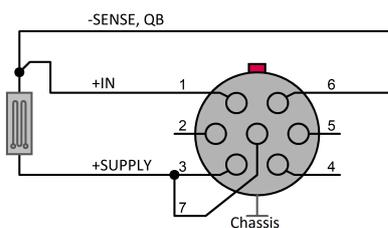
Abb. 27: Anschlußschema B-4 Viertelbrücke
