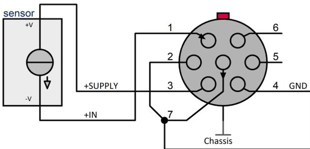
Abb. 37: unipolare Versorgung des Sensors 5 V bis 15 V (UTI-6)
