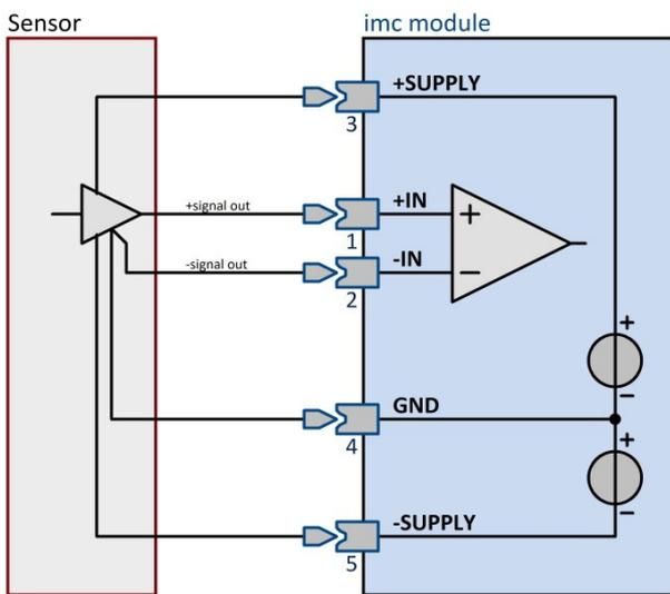
Abb. 40: UTI-6 mit einem nicht-isolierten Umformer
