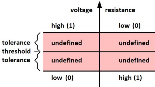
Der Bereich zwischen den Schwellwerten ist undefiniert (undefined). Wenn das Eingangssignal die obere Schwelle überschreitet oder die untere unterschreitet, liegen verlässliche High- bzw. Low.-Pegel an. Innerhalb des undefinierten Bereichs sind die Signale nicht eindeutig (häufige Umschaltungen sind möglich).
