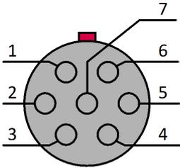
Abb. 44: GPS Buchse (Basiseinheit) (Sicht auf die Buchse)
