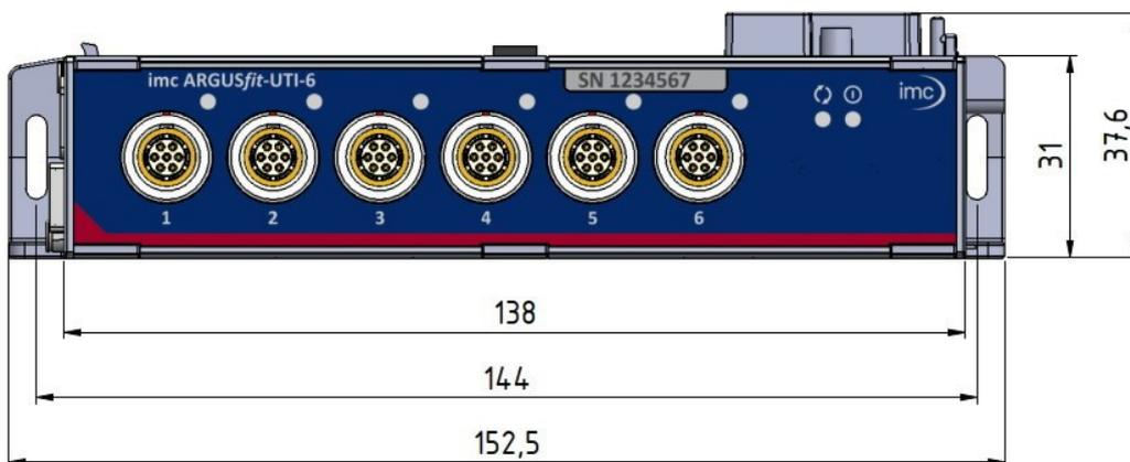
Abb. 13: Standardgehäuse, schmal: UTI-6, ICPU-6, Fiber-Converter, CAN FD-Interface und der B-4
