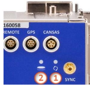
Abb. 9: LEDs der ARGFT-BASE
